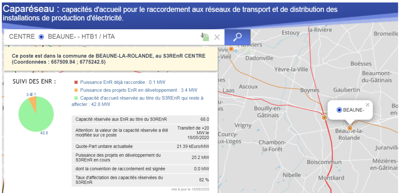
Figure 5 : Localisation du poste source le plus proche disposant de la capacité disponible pour le raccordement (source : caparéseau.fr)
